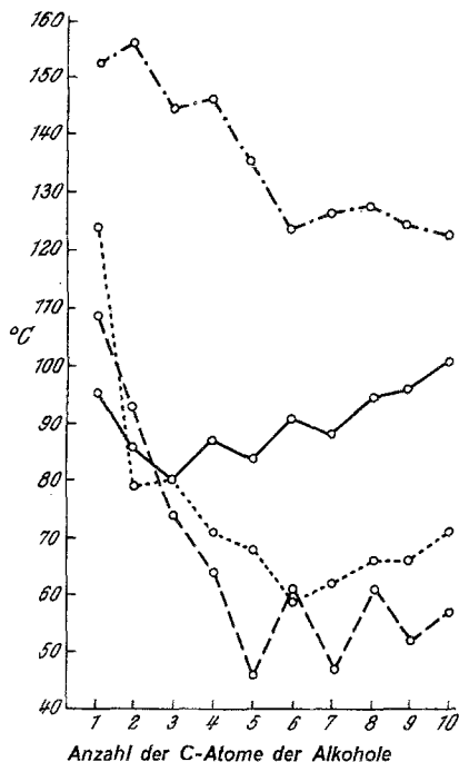
Abb. 2. Abhängigkeit der Schmelzpunkte verschiedener Derivate aliphatischer Alkohole von der Kettenlänge der Alkohole
